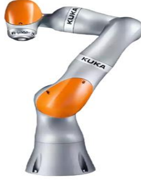
Şekil. 3.2: LBR IIWA 14 R820 Robot Kolu (URL-4,2022)
