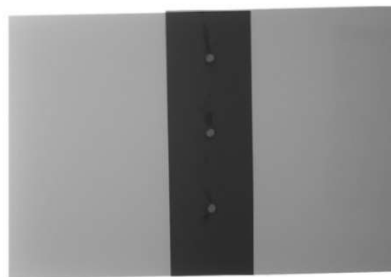
b) Radyografik yöntemle elde edilmiş kaynak filmi görüntüsü
