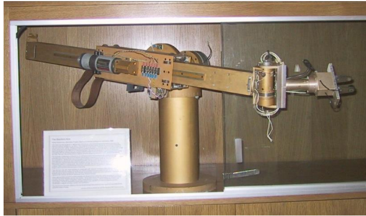
Şekil.3.1: Stanford Robot kolu (URL-2,2022)
